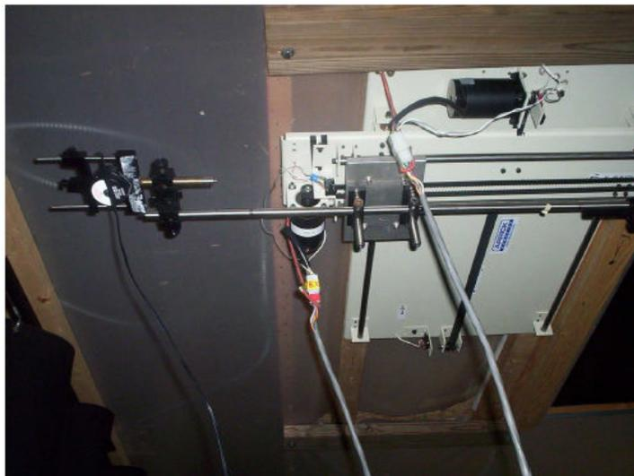
*FIGURA 4.5. Motor de translação utilizado para realizarmos o mapeamento do telescópio.*
