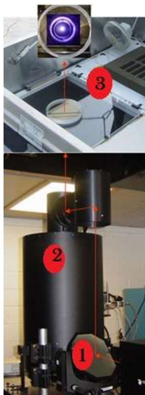
Figura 4.8 – Composição mostrando o espelho de transmissão (1), o corpo do telescópio (2) e a posição da janela de Starphire com a abertura de quartzo (3).
