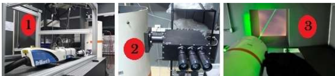
Figura 4.2 – 1) Módulo transmissor do sistema MSP-Lidar1, 2) Módulo receptor do sistema MSP-Lidar composto por um Telescópio Newtoniano, a caixa de detecção de sinal composta por 6 tubos fotomultiplicadores e filtros espectrais, 3) Visão do teto do laboratório com a emissão do feixe nos três comprimentos de onda, com a cor verde dada pelo segundo harmônico em 532nm.
